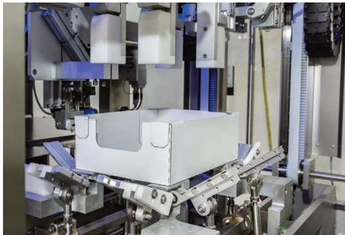
Mit den Endverpackungsanlagen lassen sich Beutel, Trays, Tiefziehpackungen, Aluminiumschalen, Dosen, Flaschen und Gläser in Kartonagen verpacken.
